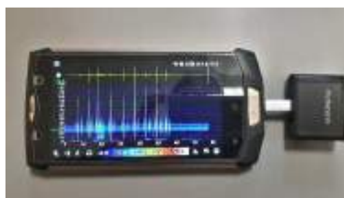
Figure 11 : Micro Pettersson u256 USB Ultrasound Microphone relié à l'application BatRecorder
